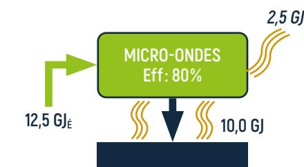
Le rendement global du séchoir alimenté par une PAC est de 208%. Celui du séchage par micro-ondes est de 80%, mais le temps de séchage pourrait être réduit.
