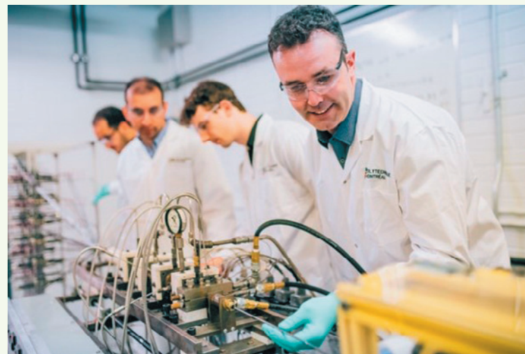
Le professeur Louis Laberge-Lebel et ses étudiants valident le contrôle de la qualité d'une tige thermoformée sur un prototype de pultrusion développé et breveté par cette même équipe.
